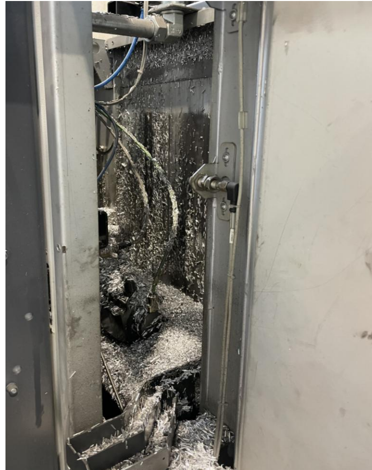
Отделение за задвижване на грипера пълно със стружки
