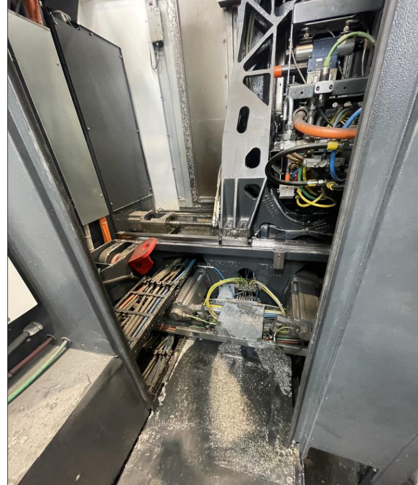
Зад машината при движещите се части натрупване на стружки
