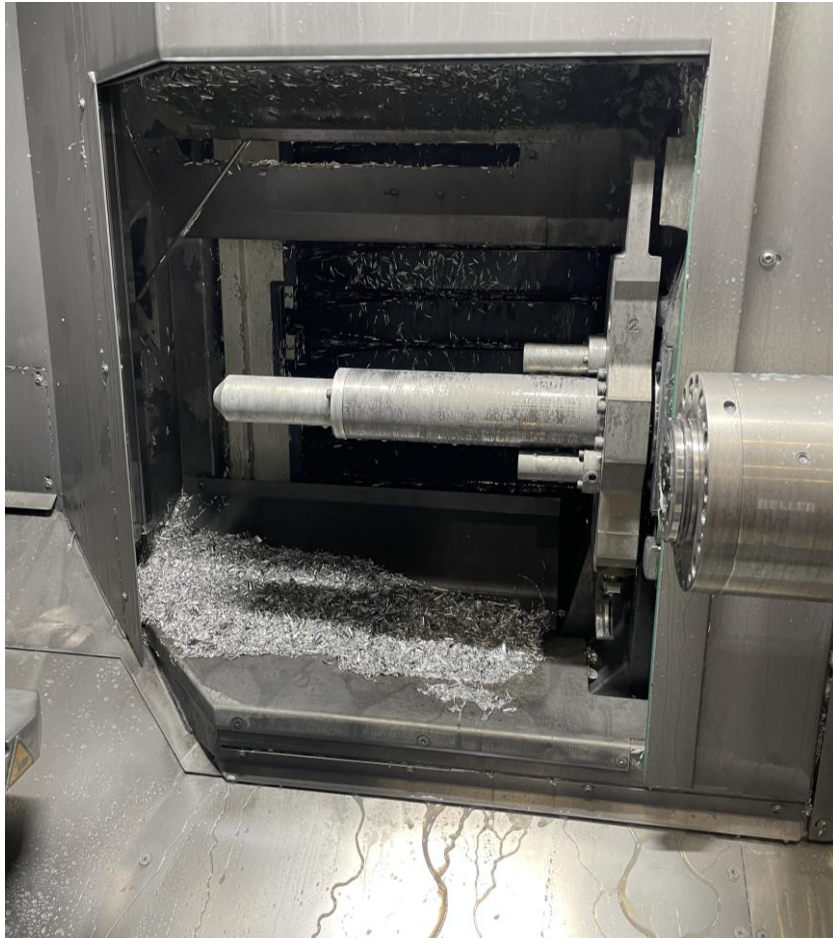
Грипер за смяна на инструменти пълнен със стружки
