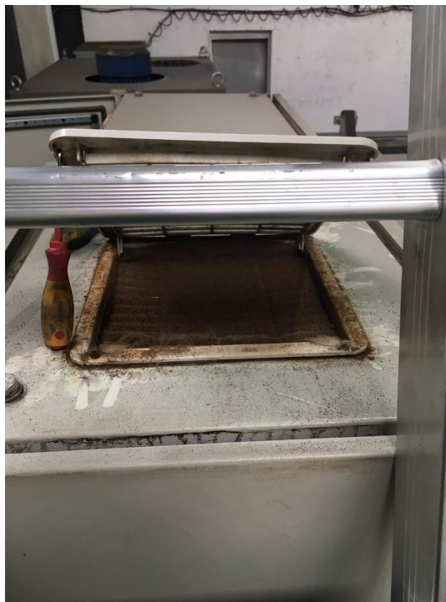
Лазер BLM замърсен филтър
